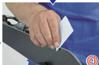
④ トップやテールのエッジが鋭く立ちすぎている場合、雪質によってはスキーが雪面に引っかかって思うようにターンできないこともあります。サンドペーパー＃320か＃400あるいは＜サンディンググラバー＞で内側から外側に向かって軽くダリングして下さい。 ※丸めすぎないようにして下さい。
