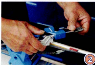
②エッジをファイリングします。このときトップ部分とテール部分は大きめの角度のガイドを使用します。※エッジを片方ずつファイリングする場合は削る方向はどちらでも構いません。
