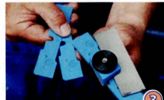
③ スチールエッジワールドカップ又はW/Cファイルガイドを使用し、目的に合わせたプレートを付けます。
