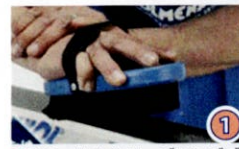
① スチールまたは、ブロンズブラシで滑走面に残っているワックスや汚れをクリーニングして下さい。
