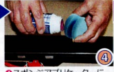
④ スポンジアプリケーターにベースワックスリキッドを塗布します。
