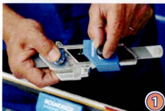
①レーシングファイルを目的角度のベースエッジ ファイルガイドに差し込みます。
