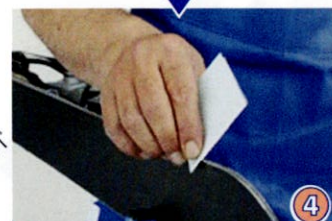
④ トップやテールのエッジが鋭く立ちすぎている場合、雪質によってはスキーが雪面に引っかかって思うようにターンできないこともあります。サンドペーパー #320 か #400 あるいは<サンディングラバー>で内側から外側に向かって軽くダリグして下さい。 ※丸めすぎないようにして下さい。
