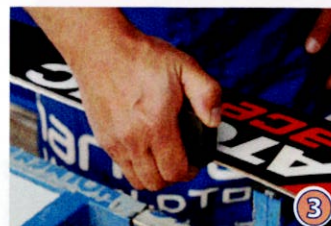
③エッジのバリ取りは、サンディングラバーで仕上げます。※バリ取りをしながらエッジ全体を磨いて下さい。(往復させても可) これにより滑らかになり、滑るエッジになります。
