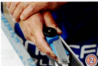
② レーシングファイルを取り付けて仕上げます。ファイルを使用する際、力を入れすぎてエッジで手を切らないようにご注意ください。
