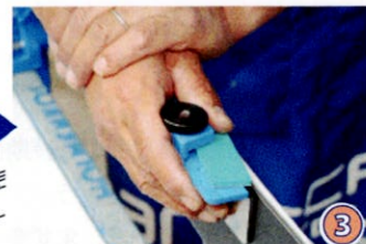
③ 雪質に応じてダイヤモンドファイルで仕上げます。
