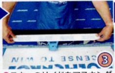
③ スキーのサイドをマスキングテープで保護すると、ワックスがビンディングに付着したり、プレートの隙間に入り込むのを防ぎます。
