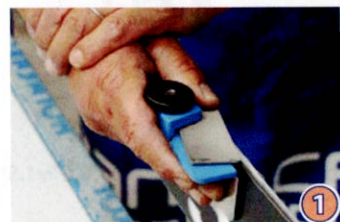
① クロスファイルで粗削りします。 ※ファイリングの際はガイド部分を滑走面におしあてて、ずれないようにして下さい。
