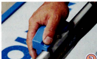
② サイドウォールプランナー又はプロでボーダーを削り取ります。 ※深く削り過ぎないように徐々に削っていきます。 ボーダー（エッジの上の出っ張り）を削ります。
